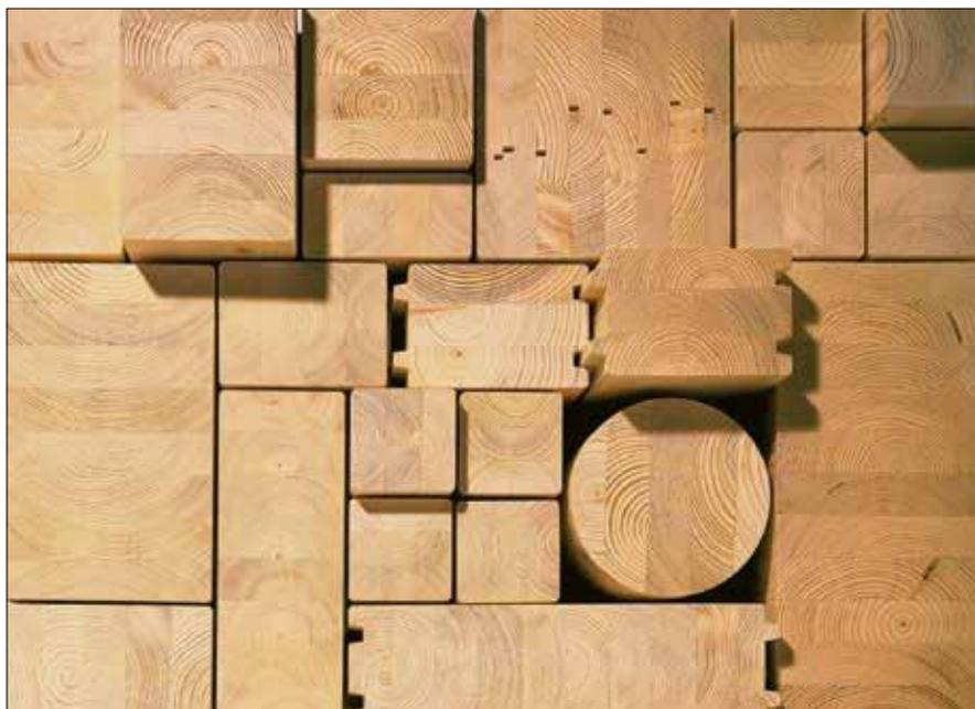
Fot. 4. Elementy z drewna klejonego warstwowo (GLULAM)
