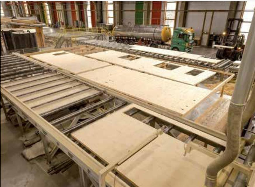
Fot. 5. Gotowa ściana CLT w hali produkcyjnej
