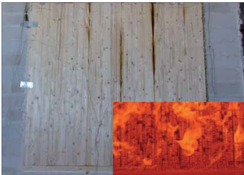
Fot. 8 | Test ogniowy ściany HBE o grubości 10 cm, na miniaturce widoczna wewnętrzna strona ściany poddana działaniu ognia. Test zakończony pomyślnie, wynik: EI60
