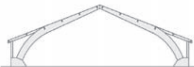
Rys. 8. Dźwigar gięty o stałym lub zmiennym przekroju (typu „hokey”), tworzący dach dwuspadowy z zachowaniem łukowej formy wewnątrz budynku. Maksymalny spadek dachu praktycznie bez ograniczeń, dzięki układowi trójpregubowemu złożonemu z dwóch elementów możliwe do uzyskania olbrzymie rozpiętości.
