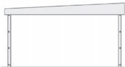
Rys. 2. Dźwigar prosty o zmiennym przekroju (typu „trapez”), tworzący dach jednospadowy przy zachowaniu poziomej dolnej krawędzi konstrukcji. Maksymalny spadek połaci ~5 stopni. Maksymalna rozpiętość bez podpór pośrednich nawet do ponad 50 m.
