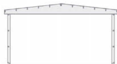
Rys. 3. Dźwigar prosty o zmiennym przekroju (typu „dwutrapez”), tworzący dach dwuspadowy przy zachowaniu poziomej dolnej krawędzi konstrukcji. Maksymalny spadek połaci ~5 stopni. Rozpiętości nawet do ponad 50 m.
