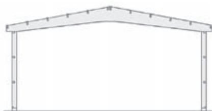
Rys. 5. Dźwigar gięty o zmiennym przekroju (typu „bumerang”), tworzący dach dwuspadowy o zakrzywionej dolnej krawędzi konstrukcji. Maksymalny spadek połaci ~15 stopni. Rozpiętości nawet do ponad 50 m.
