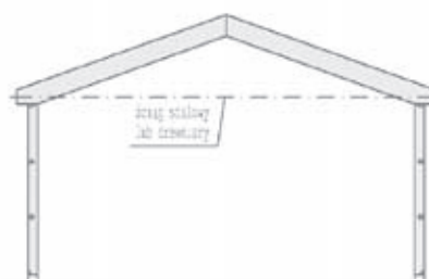
Rys. 7. Dźwigar prosty o stałym lub zmiennym przekroju ze ściągiem drewnianym, stalowym lub bez ściągu, tworzący dach dwuspadowy.
