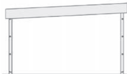
Rys. 1. Dźwigar prosty o stałym przekroju, tworzący dach jednospadowy. Maksymalna rozpiętość bez podpór pośrednich uzależniona od możliwości produkcyjnych i transportowych, nawet do ponad 50 m.
