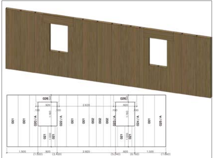
Fot. 6 | Schemat konstrukcji ściany
